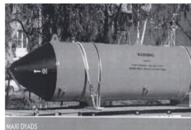
Рисунок 10 – Внешний вид магнитного модуля трала-имитатора Maxi Dyad на ложементе
