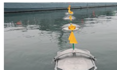
Рисунок 25 – Магнитные модули на основе кольцевых обмоток EEG трала-имитатора MSMAM
