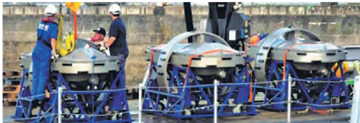
Рисунок 27 – Электромагнитный тральный комплекс Promenika в составе трёх модулей EEG
