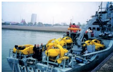
Рисунок 23 – Магнитные модули на основе ортогональных катушек трала-имитатора Sterne на штатных местах на корме корабля-тральщика
