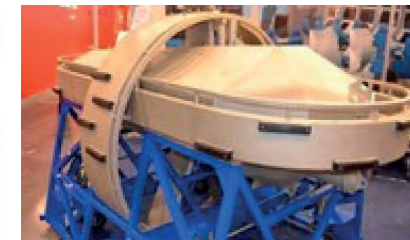
Рисунок 26 – Магнитный модуль EEG со смещённой вниз вертикальной обмоткой, входящий в состав трала-имитатора MSMAM, общий вид
