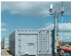
Рисунок 28 – Пост управления катером-буксировщиком по радиоканалу в стандартном контейнере ISO
