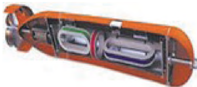
Рисунок 38 – Общее устройство магнитного трала SMMS (Superconducting Mine Magnetic Sweep)
