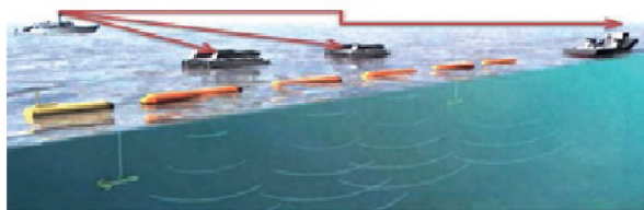
Рисунок 36 – Концепция телеуправления системой «контролируемого» неконтактного траления BMC Нидерландов NLRCIMS, включающая управление СТНТ типа SAM-3 и кораблём-буксировщиком магнитных и акустических модулей трала-имитатора типа Mini Dyad или TOMAS
