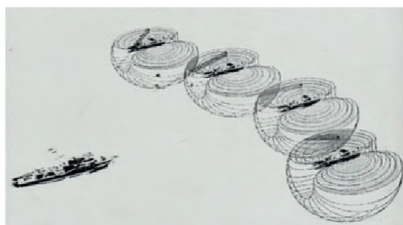
Рисунок 3 – Схема траления системой «Квадрига» (4 трала-катера HFG F-1 и корабль управления типаWolfsburg)
