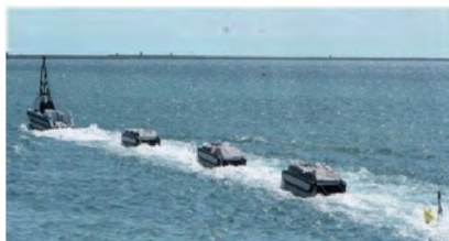
Рисунок 29 – Опытный образец автономного неконтактного трала-имитатора МНС. В правом нижнем углу поддерживающий буй акустического излучателя типа PNM/AAG
