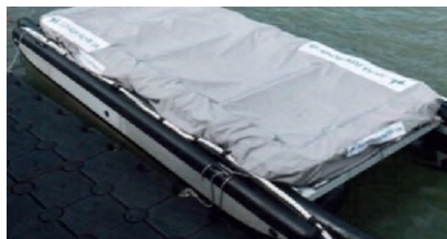
Рисунок 27 – Буксируемый плот с блоком магнитных катушек
