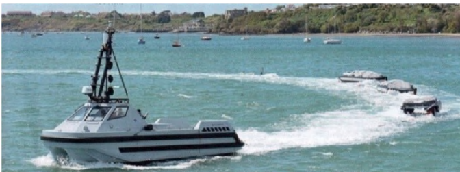
Рисунок 23 – Общий вид опытного образца автономного неконтактного трала-имитатора МНС. На переднем плане безэкипажный катер-буксировщик Hussar катамаранного типа
