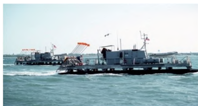
Рисунок 19 – Применение в США самоходных неконтактных тралов на базе катамарана типа SAM-3 строем уступа
