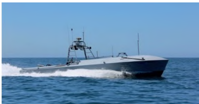
Рисунок 40 – Безэкипажный катер CUSV – буксировщик системы неконтактного траления для кораблей прибрежной зоны США
