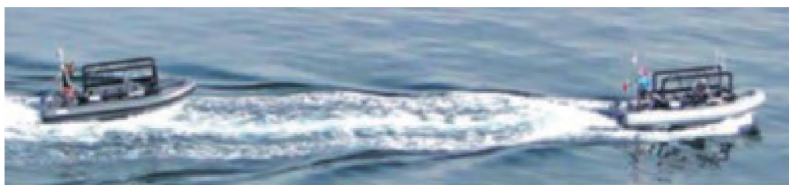
Рисунок 32 – Имитация БЭК UAPS20A проходной характеристики МПК надводной цели соответствующего водоизмещения и длины при тралении донных мин
