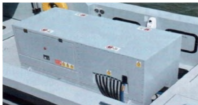
Рисунок 26 – Генератор питания магнитных катушек на борту безэкипажного катера-буксировщика Hussar
