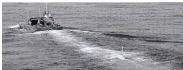
Рисунок 33 – Трал-имитатор Micro Dyad буксируется телеуправляемым БЭК типа SAV
