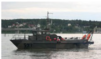
Рисунок 6 – Дистанционно управляемый катер Kiiski – буксировщик электродного трала
