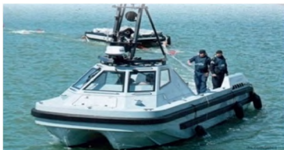
Рисунок 25 – Тральный расчет готовит катер-буксировщик Hussar. На заднем плане плот с блоком магнитных катушек
