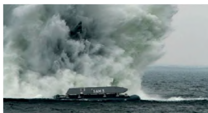
Рисунок 10 – Испытания СТНТ SAM-3 на взрывостойкость
