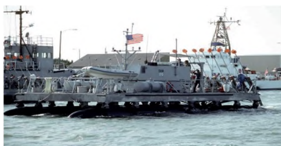
Рисунок 18 – Самоходный неконтактный трал США на базе катамарана типа SAM-3
