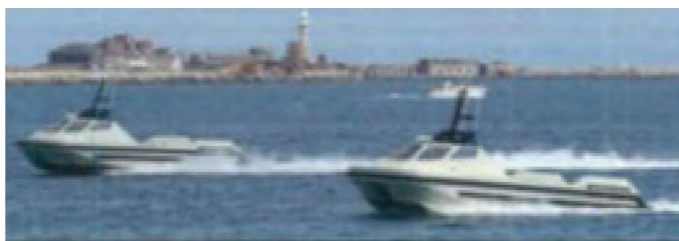
Рисунок 24 – Применение катеров типа Hussar в виде двух безэкипажных USV-носителей строем фронта или уступа
