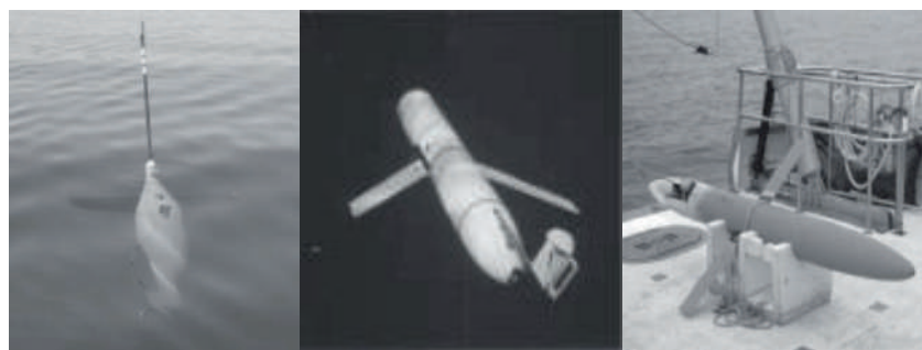
Рисунок 4 – Рабочие образцы подводных глайдеров МО ВМС США первого поколения (слева направо: Sea Glider, Slocum, Spray)
