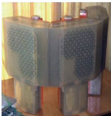
Рисунок 13 – Макет антенного устройства для сектора обзора 180° и установка ВГУ на охраняемой акватории
