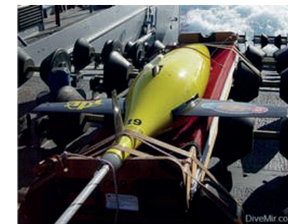
Рисунок 2 – Подводный планер Sea Glider на палубе судна в готовности к развёртыванию
