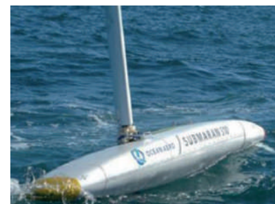
Рисунок 5 – Гибридный глайдер со складным жёстким парусом
