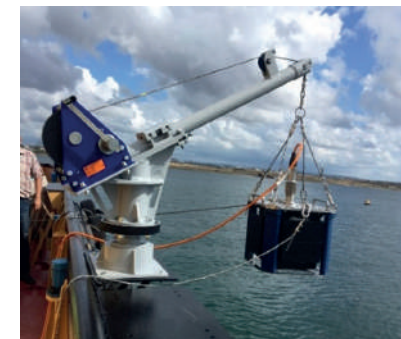
Рисунок 14 – Опускаемая антенна ГАС освещения ближней подводной обстановки
