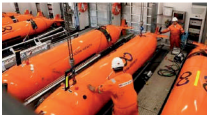
Рисунок 6 – Комплект АНПА «Хьюджин» на борту спасательного судна «Сиберд Констрактор»
