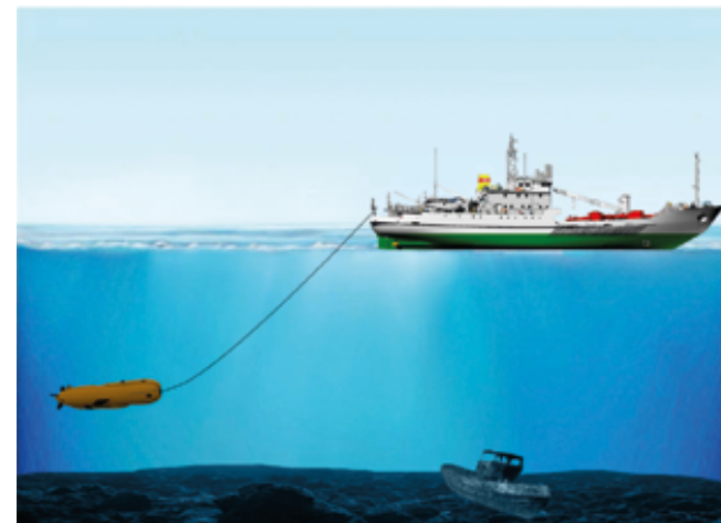
Рисунок 1 – Схема использования буксируемого подводного аппарата
