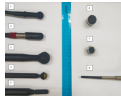
Рисунок 8 – Гидрофоны собственной разработки и внесённые в госреестр средства измерений: А – для низкочастотного диапазона сферы диаметром D = 30 мм (3), 20 мм (4), 7 мм (5) в сравнении с гидрофонами фирмы «Bruel&Kjaer» (1 – тип 8105, 2 – тип 8104); Б – для высокочастотного диапазона (2041.017.000 (6), 2041.018.000 (7)) и гидрофон ГИ800 (8)
