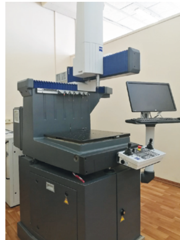
Рисунок 3 – Координатно-измерительная машина DURAMAX 5/5/5 RT CNC
