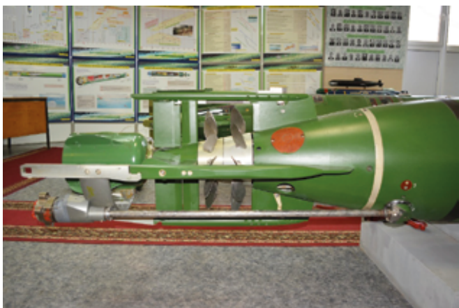
Рамная ХЧ торпеды ТЭ2-02, разработанной на базе торпеды УСЭТ-80
