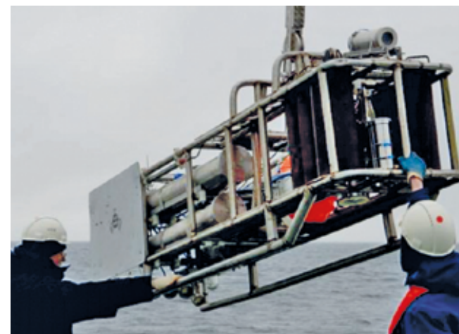
Рисунок 2 – Буксируемый подводный аппарат «Видеомодуль»
