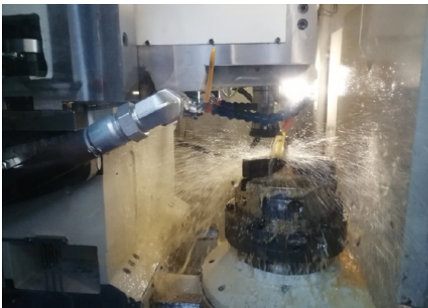
Рисунок 2 – Формирование зуба на станке GP3000S
