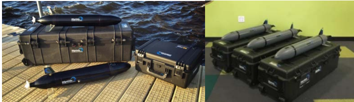
Рисунок 15 – Образцы малых автономных подводных аппаратов компании Риптайд (Micro-UUV, RipTide), разработанных для военно-морских сил США [7]
