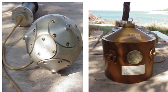
Рисунок 3 – Модификации комбинированных векторно-фазовых пьезокерамических приемников.
