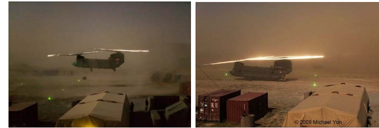
Рисунок 1 – Коронирующие разряды на лопастях вертолетных винтов
