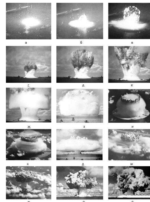
Рисунок 2 – Фотографии активной стадии развития подводного ядерного взрыва «Baker» 23 кТ на глубине 27,5 м при глубине акватории в районе взрыва около 60 м
