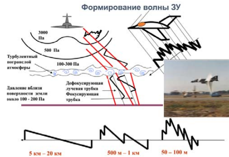
Рисунок 9 – Формирование звукового удара и N-волны по мере распространения волны от СПС к поверхности земли
