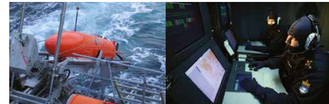
Рисунок 13 – Спуск автономного подводного аппарата (UUV) с борта корабля (слева) и командный пункт управления маневрами UUV (справа)
