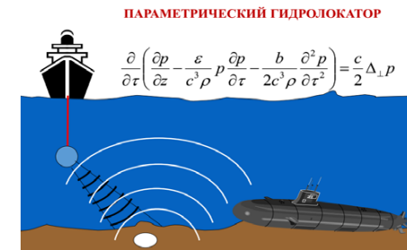
Рисунок 8 – Уравнение ХЗК, описывающее параметрический гидролокатор, и некоторые приложения
