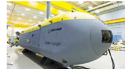
Рисунок 12 – Модификация автономного подводного аппарата Echo Voyager для долговременных комплексных подводных исследований [6]
