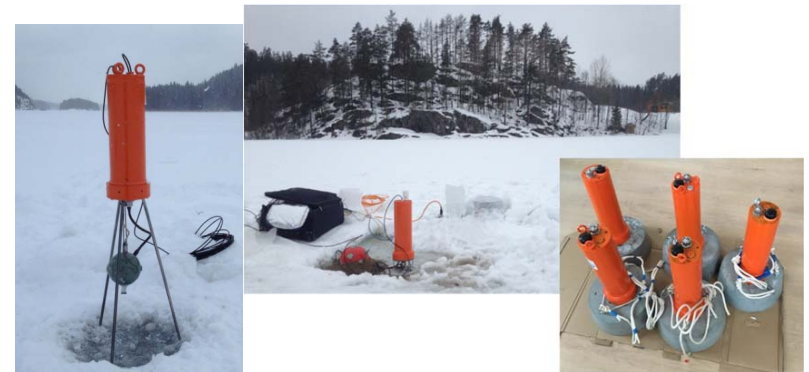
Рисунок 2 – Испытания макетов вмораживаемых геогидроакустических буйев и отдельных элементов дрейфующих антенных систем
