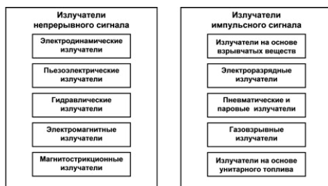
Рисунок 2 – Классификация излучателей ЗП в НЧ и ИНЧ диапазонах
