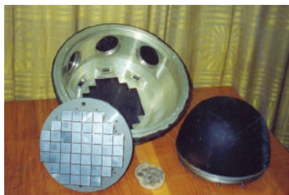
Рисунок 10 – Корпусные элементы, обтекатели и блоки пьезопреобразователей гидроакустических антенн подводных аппаратов
