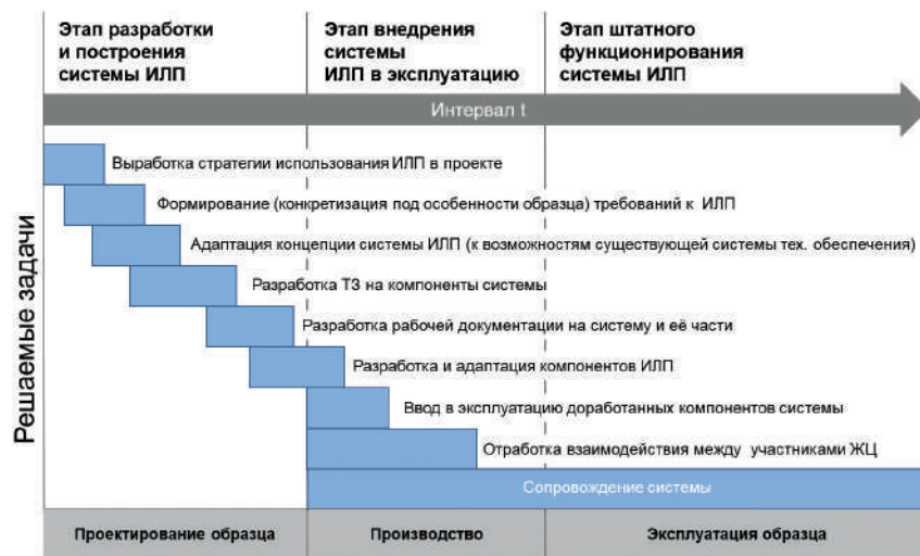
Рисунок 5 – Схема формирования системы ИЛП в процессе ЖЦ
