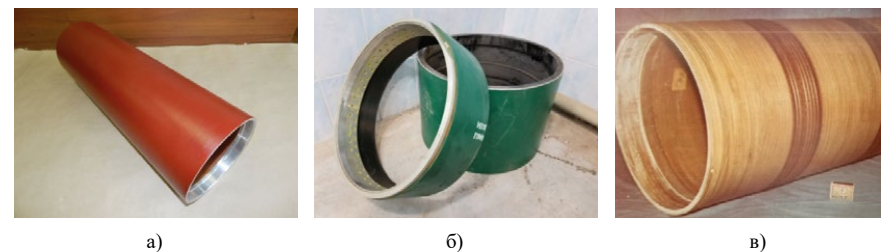
Рисунок 3 – Корпуса изделий из композиционных неметаллических материалов: а) корпус отсека калибра 220 из углепластика; б) фрагменты корпуса калибра 533 из углепластика; в) корпус батарейного отсека из стеклопластика ЭДТ-10П
