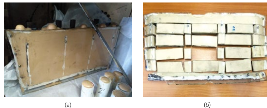
Рисунок 5 – Фотография массогабаритного макета детали (а) и образцов из неё после отверждения заливочной композиции (б)
