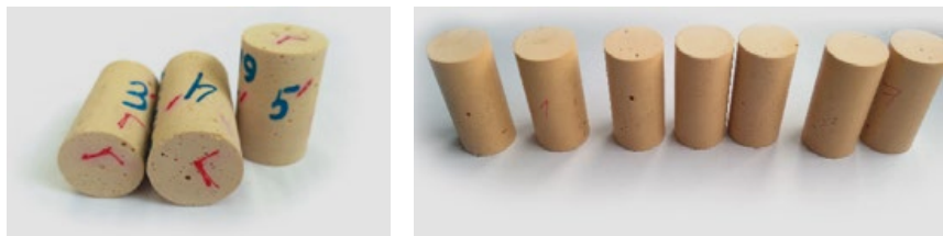
Рисунок 3 – Фотографии некоторых изготовленных образцов сферопластика
