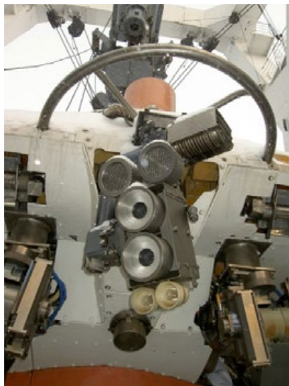
Рисунок 1 – Телекамеры и светильники наружного освещения, размещённые на глубоководном аппарате «Русь»
