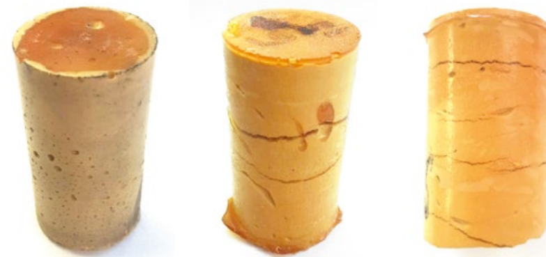
Рисунок 2 – Фотографии отбракованных образцов из сферопластика
