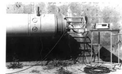
2) Измерение удельного поперечного сопротивления ЛКП
