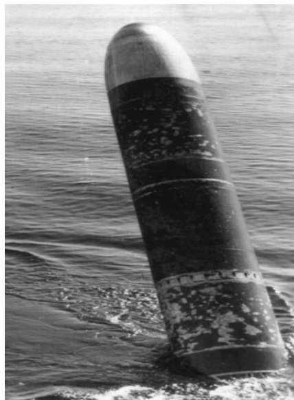
Рисунок 6 – Всплывающий макет торпеды после испытания
