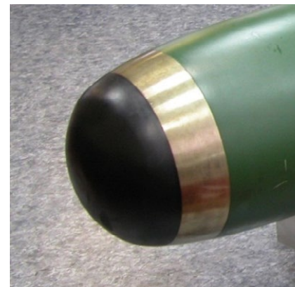
Рисунок 5 – Одна из модификаций опытного образца антенны ССН торпеды УМГТ-1
