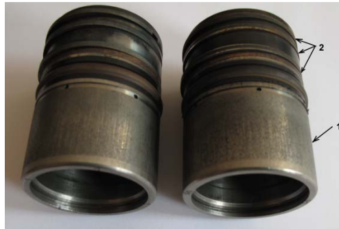
Рисунок 12 – Вид поршней из сплава ПТ-3В в сборе с поршневыми кольцами из стали 4Х5МФ1С после эксплуатации: 1 – покрытие молибденом на поршне; 2 – покрытие молибденом на поршневых кольцах
