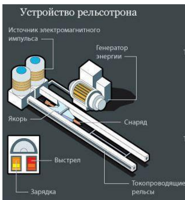
Рисунок 1 – Принцип действия электромагнитной пушки
