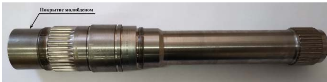
Рисунок 13 – Вид вала ХЧ из сплава ПТ-3В с покрытием молибденом после эксплуатации
