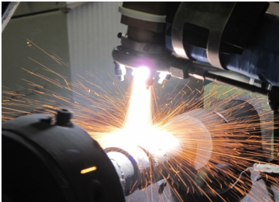
Рисунок 2 – Плазменное напыление покрытия из молибденовой проволоки на поршневые кольца ЭДМ
